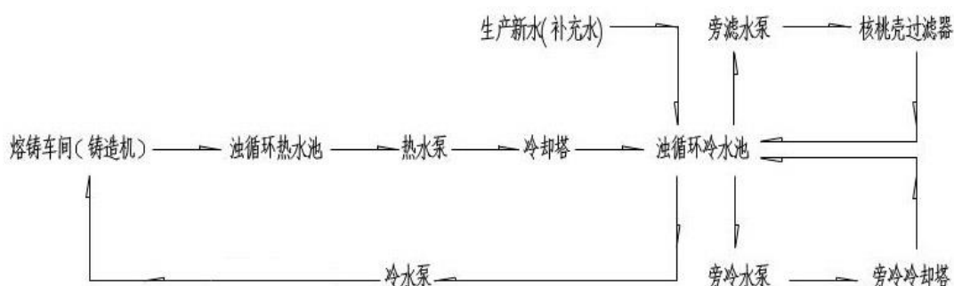
图 4.1-3 浊循环水系统废水收集利用流程示意图
