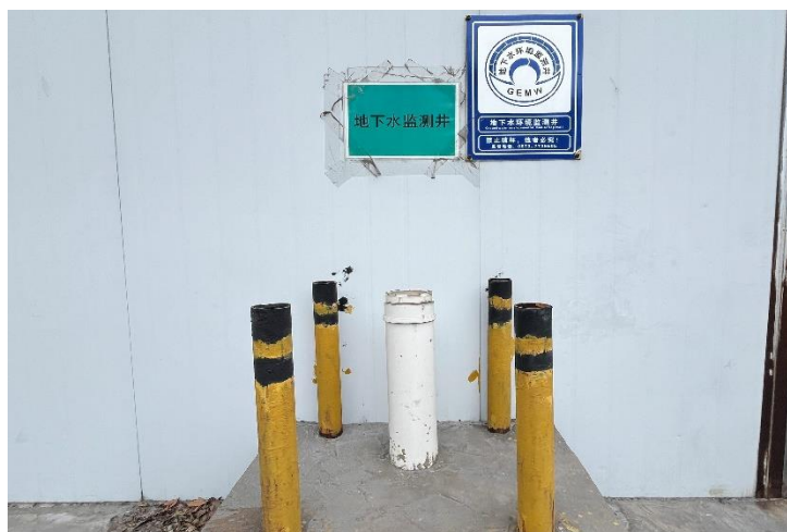
图 4.2-1 地下水跟踪监测井
